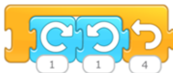
rys. 12 Skrypt czterokrotnego powtórzenia obrotu prawo - lewo Gotowy skrypty łączymy w całość.
